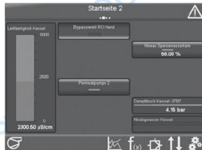
Система позволяет обрабатывать цифровые и аналоговые сигналы, а также устанавливать пороги переключения и сигнализации. Эти сигналы могут включаться непосредственно в регуляторе или обрабатываться, например, функциями логики и вычислений. Затем они снова передаются через цифровой или аналоговый выход (модель IPO).
